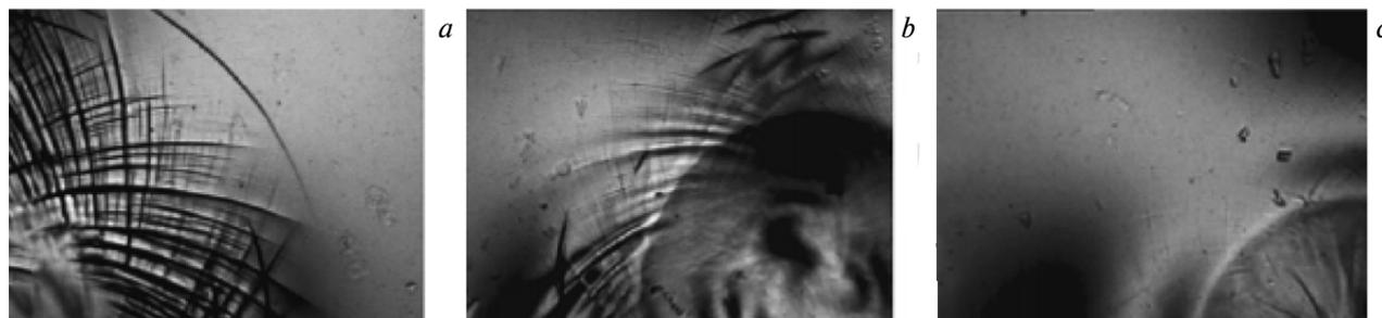
Рис. 18. Световые микрофотографии образца ПЭТФ, в котором реализованы полосы сдвига и который был далее подвергнут отжигу при 40 (a), 70 (b) и 75 °С (c)<sup>81</sup>.
