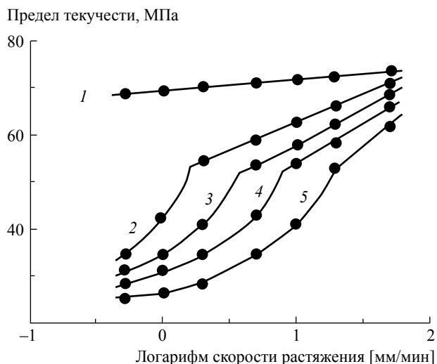
Рис. 23. Зависимость предела текучести ПЭТФ от скорости его растяжения на воздухе (1), в n -деканоле (2), n -гексаноле (3), n -пропаноле (4) и четыреххлористом углероде (5) [24]. Толщина пленки 305 мкм.
