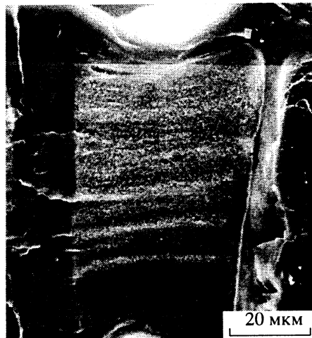
Рис. 4. Микрофотография образца никельсодержащего композита, полученного на основе ПМ-1 при содержании глицерина в растворах 20 об. %.
