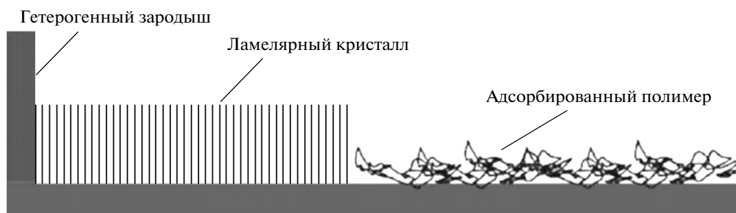
Рис. 45. Схема структурных перестроек, сопровождающих рост ламелярного кристалла из тонкого адсорбированного слоя полимера [273].
